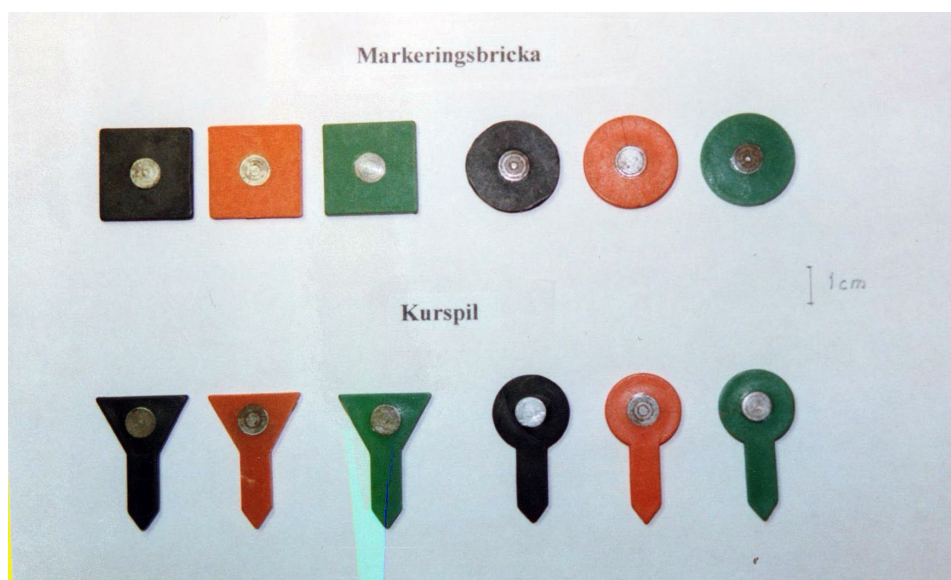
Bild 16. Markeringsbrickor och kurspilar.
