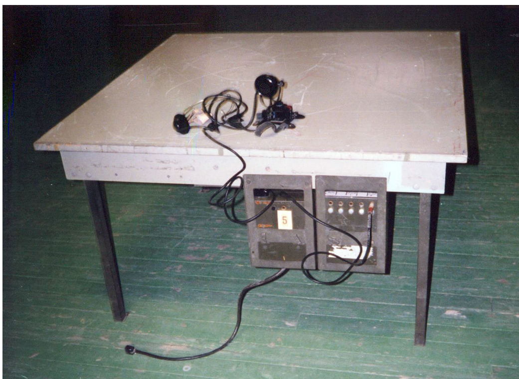
Bild 10. Bord med monterad utrustning och bröstmikrotelefon.
